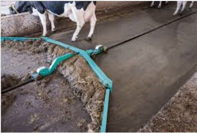
სურ. 57 ნაკელის გატანა ხვეტია ტრანსპორტიორით
