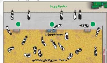
სურ. 7 სადგომში საკვებურის, საწურავების და დასასვენებელი ზონის განლაგების სქემა
